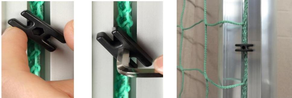
Die Spannleine durch jede Masche des Netzes führen und an den Außen-seiten am Netzbügel festknoten, ggf. durch die Bohrung im Netzbügel führen.
